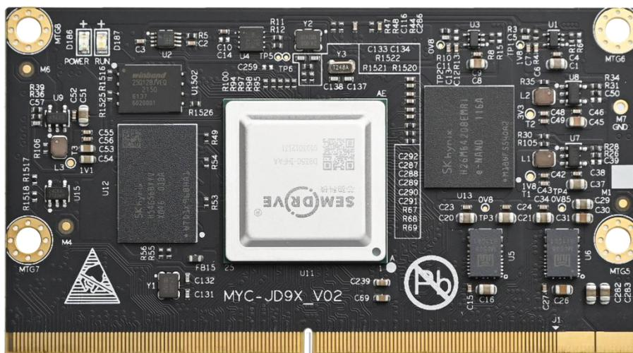
图 3-1 核心板 MYC-JD9350 正面图
