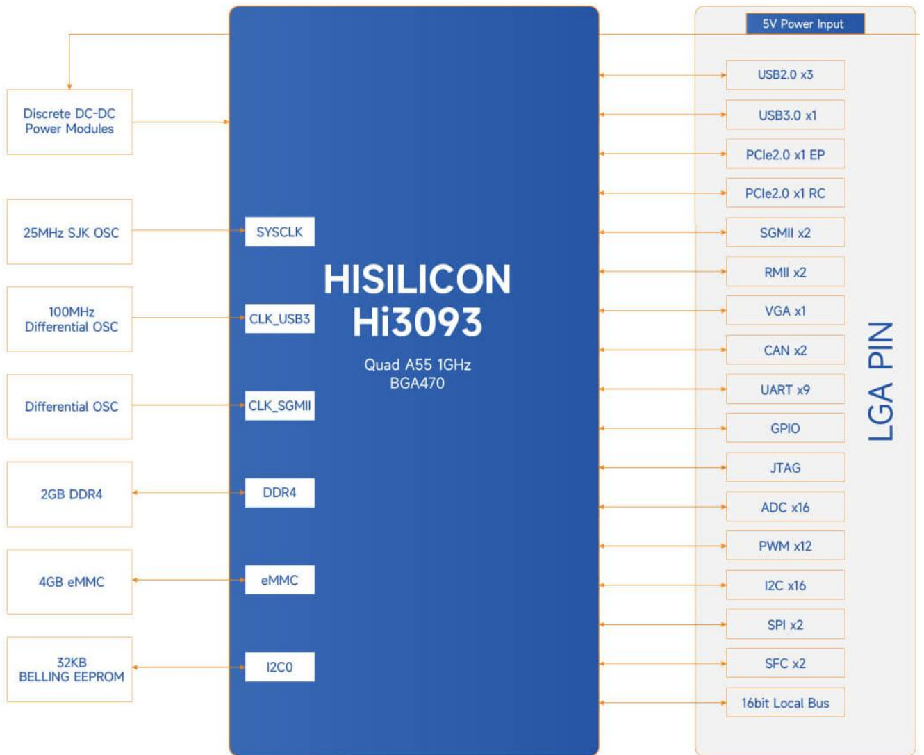
图 3-2 MYC-LHi3093 核心板系统框图
