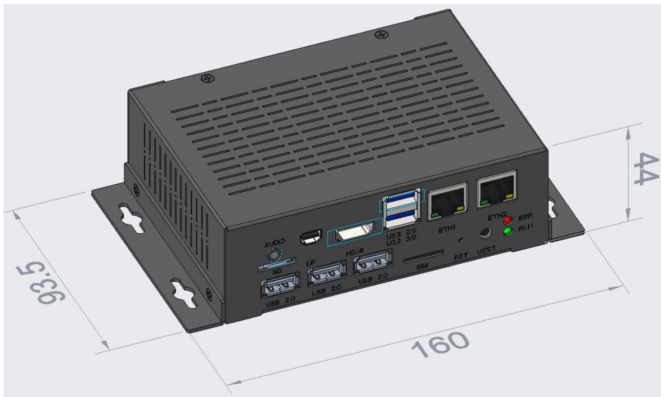
图 6-3 微型工控机机械尺寸图 (单位: mm)
