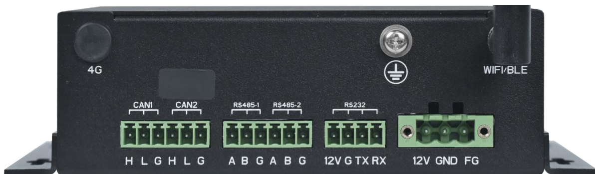
图 6-2 MYD-LT527 微型工控机接口背面图
