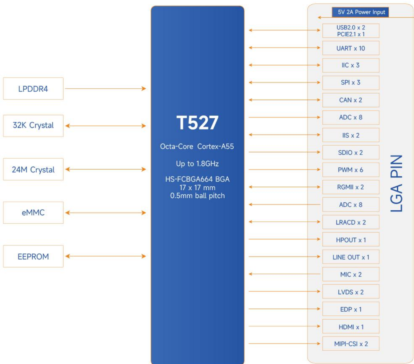
图 3-3 MYC-LT527 核心板系统框图
