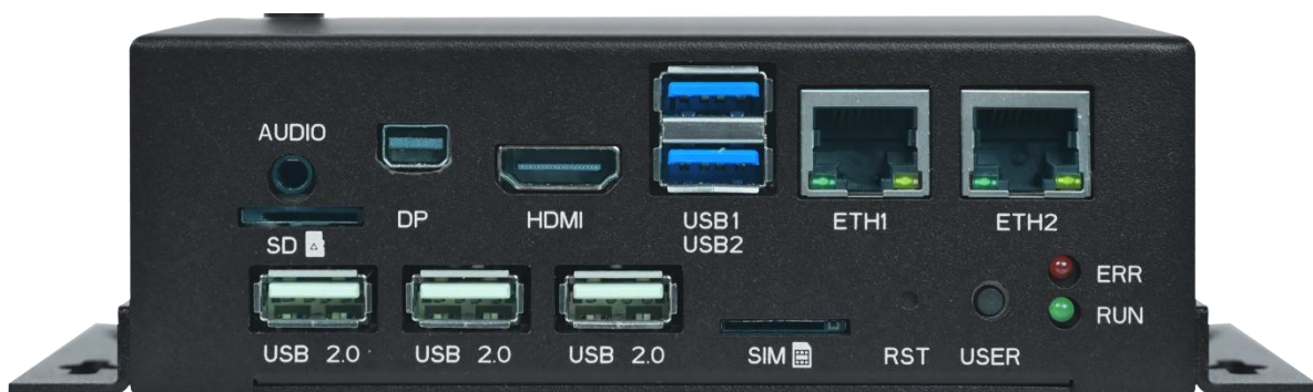
图 6-1 MYD-LT527-I-GK-B 微型工控机接口正面图
