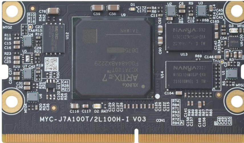
图 3-1 核心板 MYC-J7A100T 正面图
