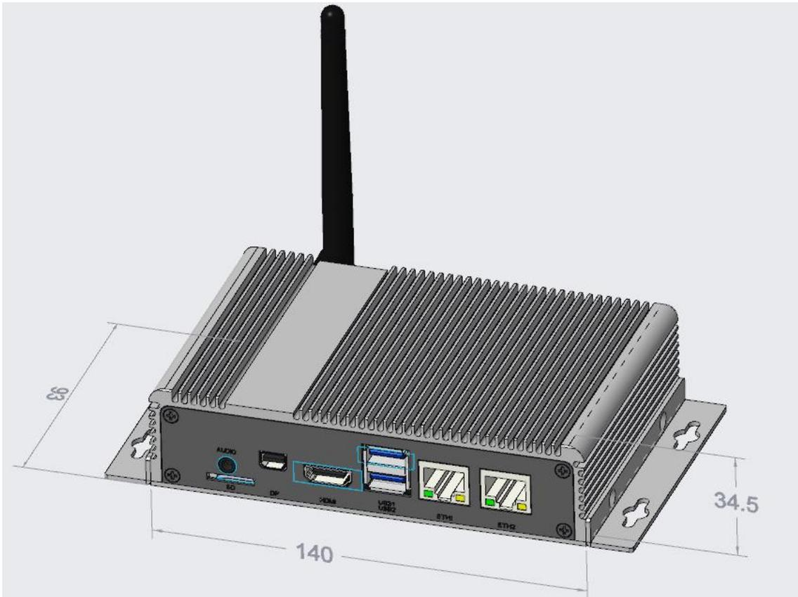
图 6-3 边缘计算盒机械尺寸图 (单位: mm)
