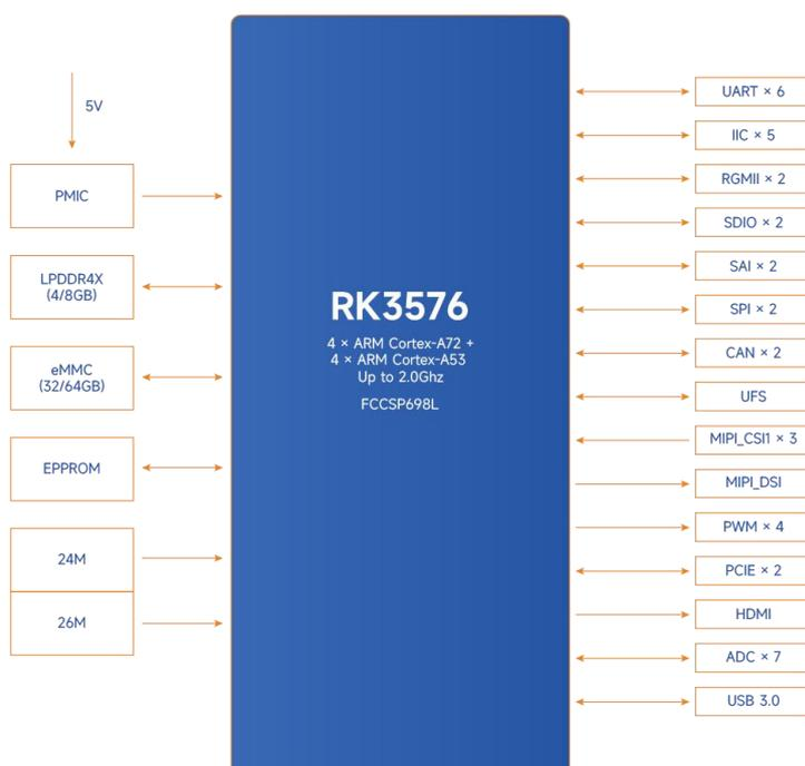
图 4-2 MYC-LR3576 核心板系统框图
