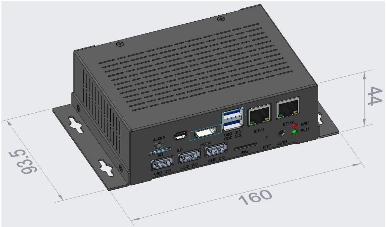
图 5-5 微型工控机机械尺寸图 (单位: mm)
