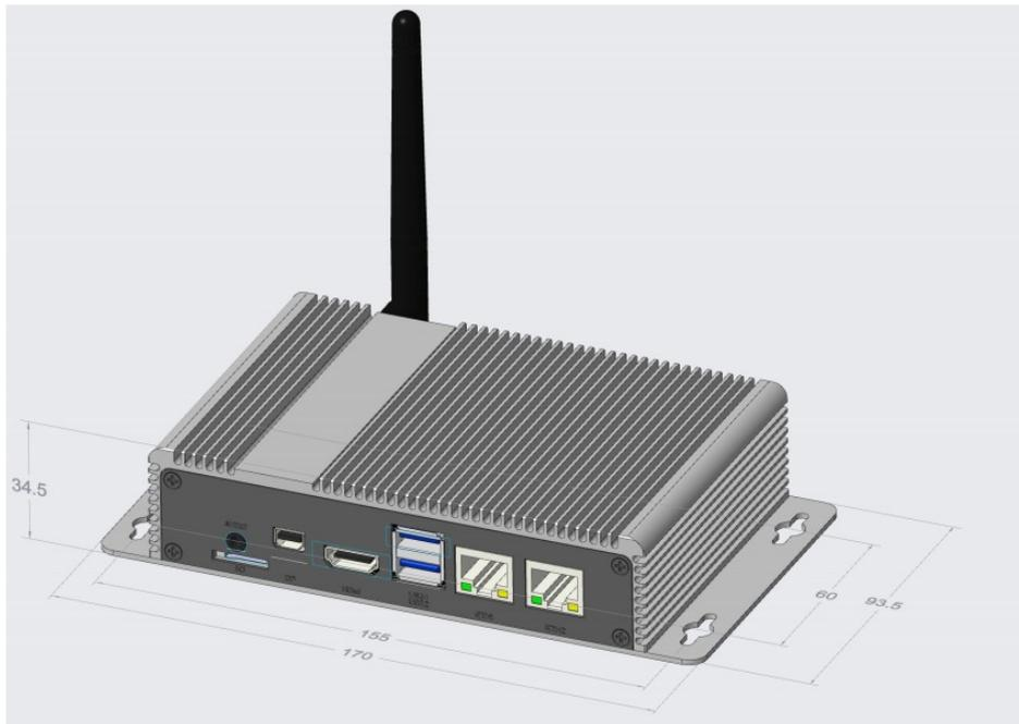
图 1-2 边缘计算盒机械尺寸图（单位：mm）
