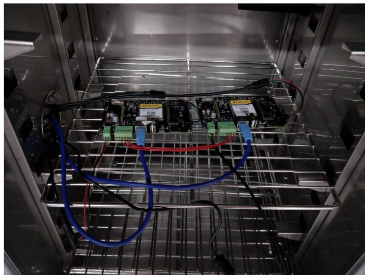
图 4-2 -40°C—85°C高低温循环测试试验
