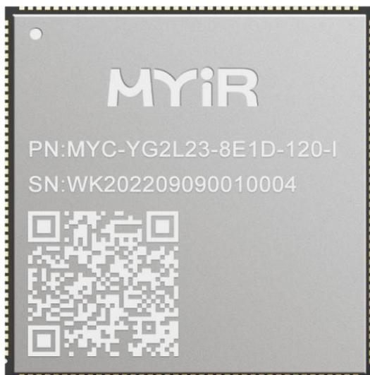
图 3-1 核心板 MYC-YG2LX 正面图
