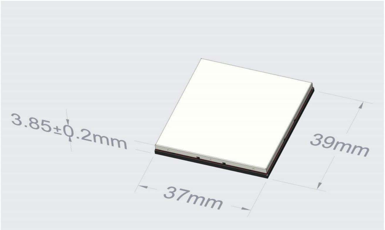
图 4-3 MYC-LMX91 核心板机械尺寸图 (单位: mm)
