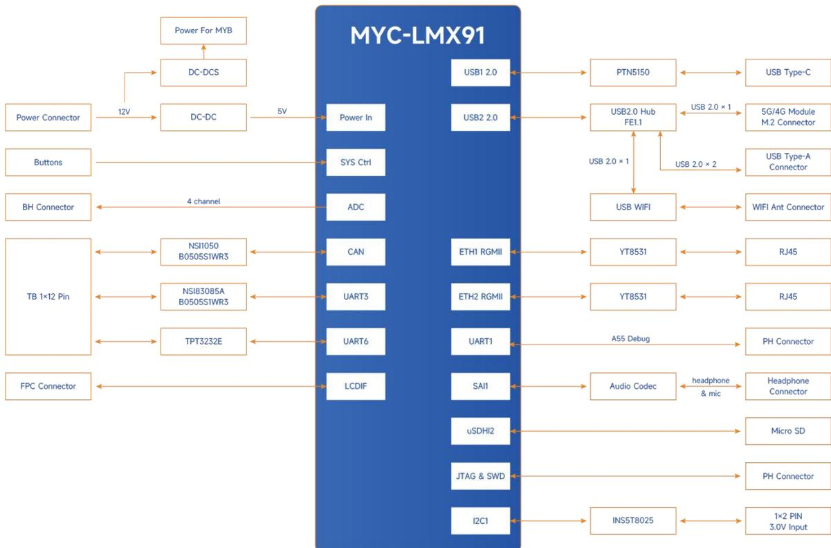
图 5-3 MYD-LMX91 开发板系统框架图
