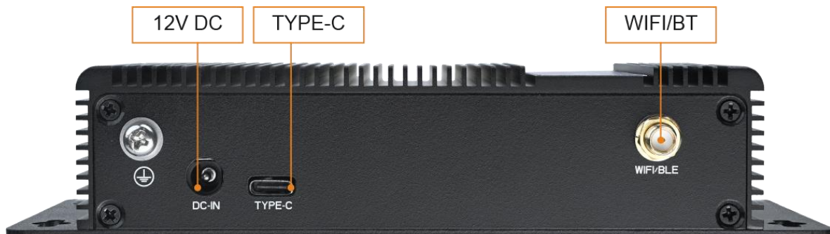
图 7-2 MYD-LR3576-B 边缘计算盒背面接口标注图
